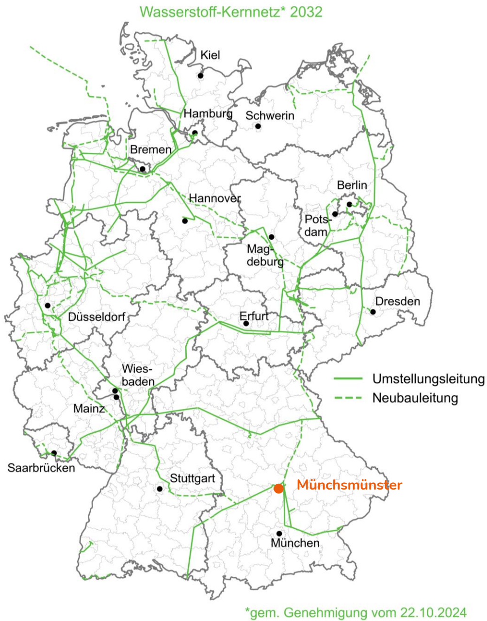
Abbildung 13: Genehmigte Planung für Wasserstoff-Kernnetz [Quelle: FNB Gas 2024]
